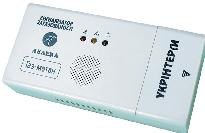
При возникновении загазованности сопротивление чувствительного элемента прибора уменьшается, что приводит к срабатыванию граничного устройства электрической схемы сигнализатора. При этом прибор выдает световой и звуковой сигналы.
